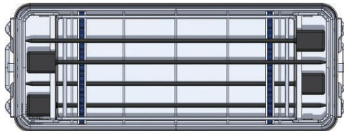
アーム先端部のバスケットへの接触を防ぐため、ストッパーを設けています。
